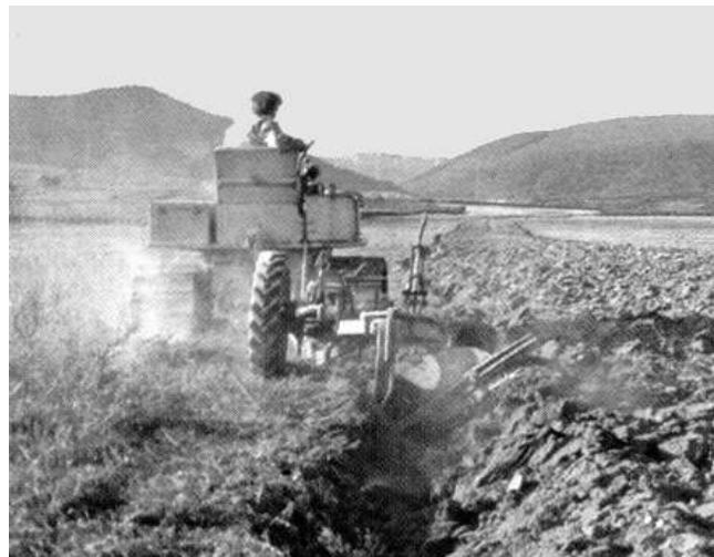
**Sl. 13.1. Rigoler sa jednim plužnim telom**
