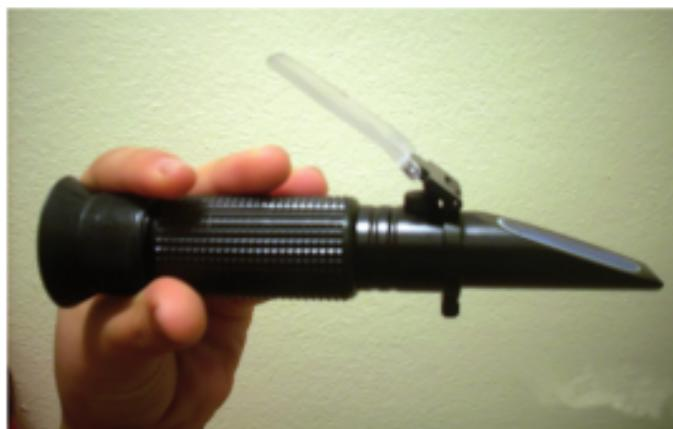
Sl. 110. Ručni refraktometar
