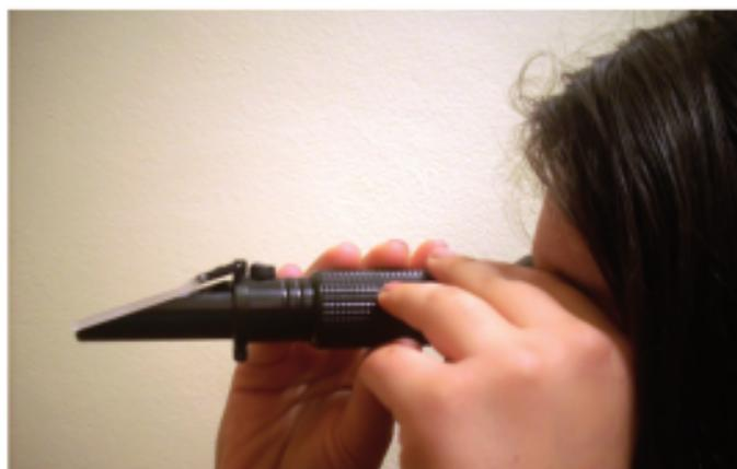
Sl. 111. Očitavanje sadržaja šećera ručnim refraktometrom
