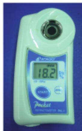
Sl. 113. Digitalni refraktometar i očitavanje sadržaja šećera
